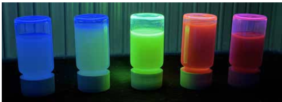
Figuur 3. Fluorescentie van \text{CsPbX}_3 -perovskiet-quantumdots onder UV-licht. De oplossingen vertonen uitgesproken emissiekleuren die overeenkomen met hun halogenidesamenstelling: van links naar rechts X = \text{Cl}, \text{Cl/Br}, \text{Br}, \text{Br/I} en \text{I} .
