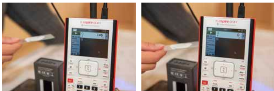
Figuur 3 en 4. Meting van de uv met de uv-sensor en TI-Nspire zonder zonnecrème (links) en met zonnecrème tussen de sensor en lichtbron (rechts)
