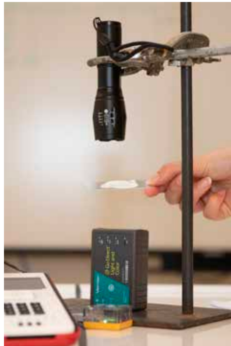
Figuur 1. Opstelling voor het meten van de uv-doorlaatbaarheid bij zonnecrème en andere materialen
