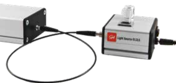
Figuur 2. De gebruikte spectrofotometer met lichtbron
